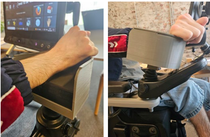
3D model som alternativ betjening til kørestol.
